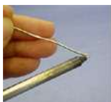
Наносите припой на головку когда включено питание паяльника.
