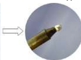
Наносите припой на головку когда включено питание паяльника.
