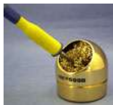
Очищайте головку сухой очистительной стружкой
