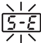
В случае возможной неисправности датчика или нагревателя (включая цепь датчика), на дисплее отображается надпись **S-E**, а питание станции отключается.
