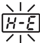
Если измеренное значение температуры падает ниже разности между текущим установленным значением температуры и значением порога предупреждения о низкой температуре, на дисплее отображается **H-E**, и раздается предупреждающий сигнал. Когда температура головки войдет в допустимые пределы, подача звукового сигнала прекратится.
