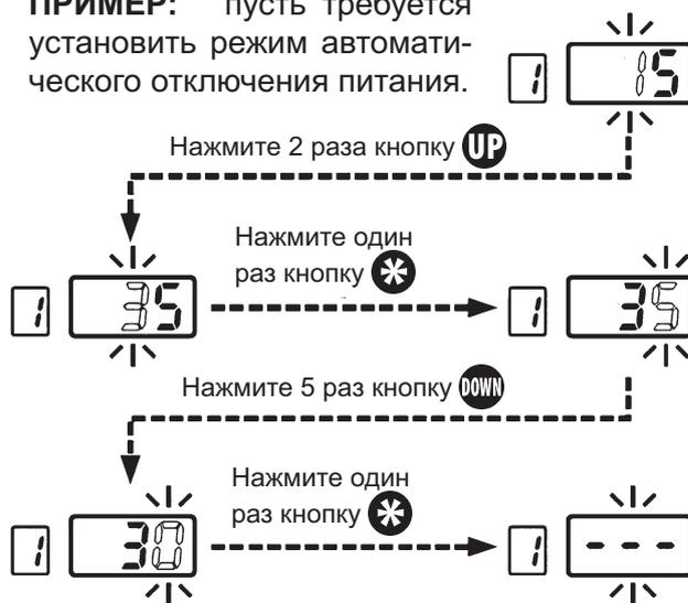
**ПРИМЕЧАНИЕ.** После установки параметра для паяльника 1 система автоматически переходит к вводу параметров паяльника 2.
