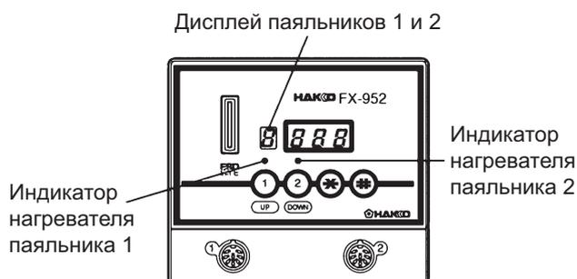
На передней панели паяльной станции HAKKO FX-952 расположены следующие органы управления:
